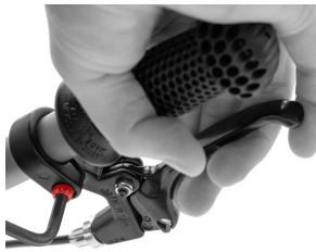
Nastavte brzdovou páku do vhodné polohy tak, aby se snadno ovládala a dotáhněte **šroub** na objímce.
