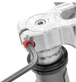
Řídítka srovnejte s předním kolem tak, aby byla osa symetrie řídítek rovnoměrná s předním kolem a poté dotáhněte **šrouby** na představci (max. 8 - 9 Nm).
